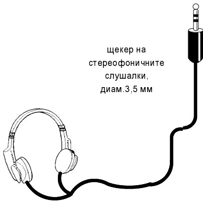
стереофонични слушалки с щекер с диам. 3,5 мм
